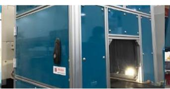
内部品質計(光センサー) ※糖度・空洞・腐れを測定
